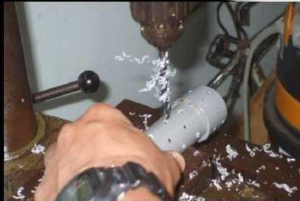
Paip PVC dilubangkan dengan menggunakan mesin drill
